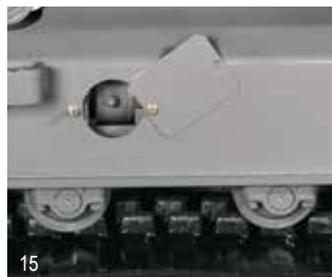
AUTOMATISCHE HYDRAULISCHE KETTENSPIANNUNG
